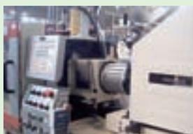
YSE（ポルトガル）では、57 台の射出成形機に使用する圧縮空気の圧力を見直し、過度な条件を適正値に調整することにより、使用する圧縮空気
