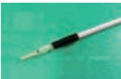
ワイヤーハーネスの軽量化に貢献するアルミ電線の採用には、端子（銅合金）とアルミ電線の腐食対策（防食）が必要となります。今回、端子とアルミ電線の接続部を樹脂で覆う構造の防食技術を開発した結果、アルミ電線の採用率は従来よりも約60%向上しました。
