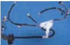
スライドドア内の機器に配線されるワイヤーハーネスは、従来、大型の成形プロテクタをドア内に配置していたため、部品が大きく、車両への組みつけに非常に苦労していました。そこで、その大型プロテクタを駆動アームに変更することで、ドア内の部品重量を従来比約70%軽量化しました。さらに、CO<sub>2</sub>排出量も約65%削減しました（LCA）。
