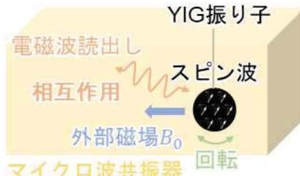
図：軟磁性体磁力計の完成系
