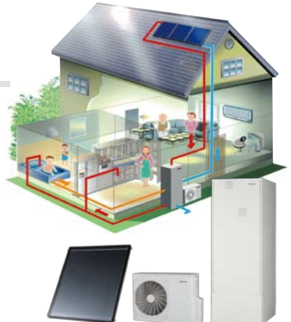
エコキュート・ソーラーヒートは(左から)ソーラーパネル、ヒートポンプユニット、貯湯槽の3つで構成されている。太陽の熱と空気の熱を有効に利用する。
