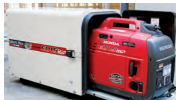
福祉避難所 11 カ所に LP ガス発電機と防音ボックスが導入されました
