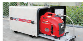
防音ボックスで雨を保護しています
