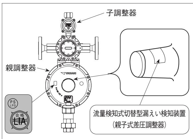
調整器合格証票および漏えい検知装置専用であることを示すシールが貼付されていることを確認してください。
