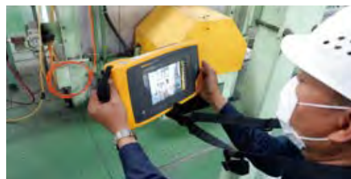
エアリー漏れ箇所の確認の様子
