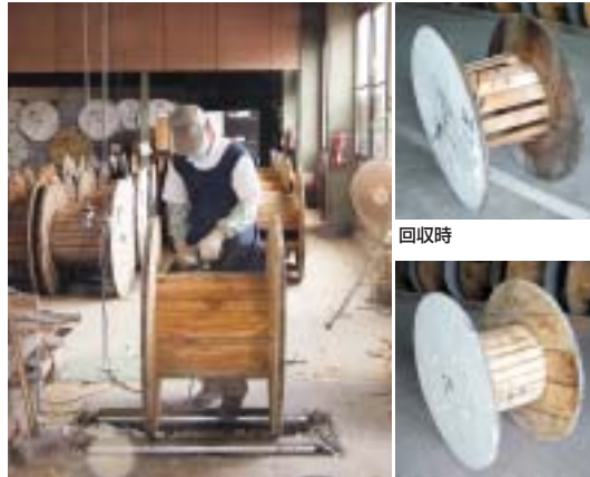
木製ドラムの補修作業
