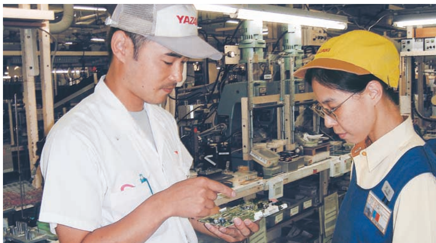
新型平型タコグラフの配線板変更個所の仕上がり確認
