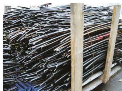
保土沢工場の廃難燃アルミラップケーブル
