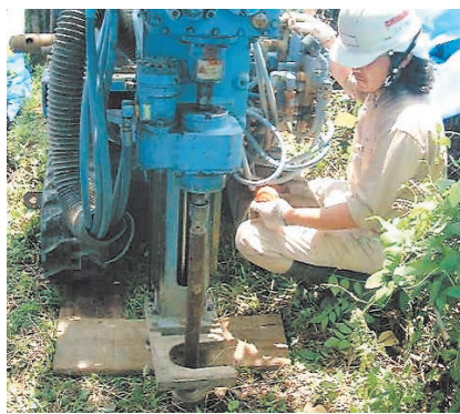
ダイオキシン類のボーリングによる土壌調査
