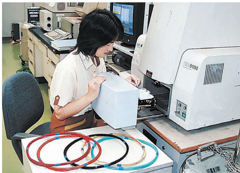
蛍光X線分析装置を用いた電線被覆材の鉛、カドミウムの測定
