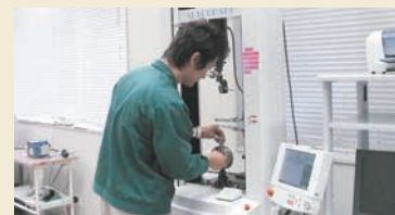
絶縁体の伸びを測定するスタッフ
