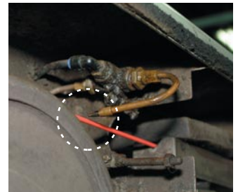
【裾野製作所】先端空気の直進性を改善した省エネ型ノズル
