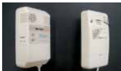
薄型・軽量ガス漏れ警報器(左:従来製品、右:新製品)
