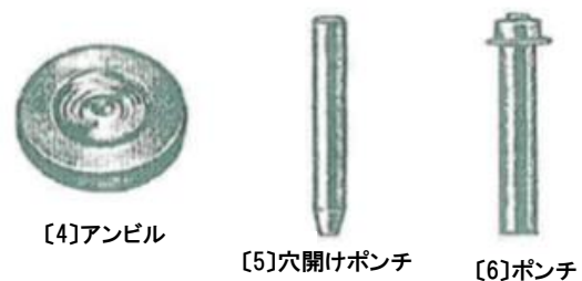
図-2 アース端子取付治具セット
