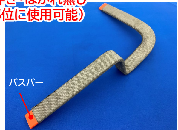
使用例) バスバーに貼付後、曲げ加工
