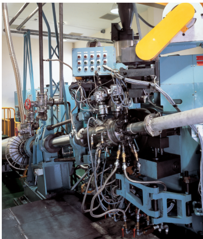
架橋ポリエチレン絶縁押出工程（沼津）
