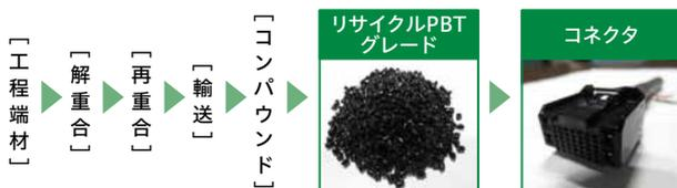
ケミカルリサイクルPBTを使用した自動車ワイヤーハーネス用コネクタ製造のプロセス
