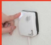
過去10日間にガス警報があったことを確認することができます。監視時に点検/警報停止スイッチを3秒以上(5秒未満)押し、「ピッピッ」と鳴動し、白(電源/常夜灯)ランプが消灯した後、過去10日間にガス警報があった場合は赤(警報)ランプが約1秒間点灯します。
