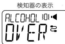
アルコール成分が検出された場合、センサに付着したアルコール成分を除去するための内部クリーニングを行います。表示される数字は内部クリーニングの残り時間です。内部クリーニング完了後に電源オフしますので、そのままお待ちください。(内部クリーニング中の電源オフ及び測定はできません。)
