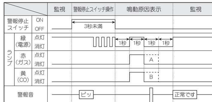
警報履歴表示により最後に発生した警報のランプが1秒点灯します。
