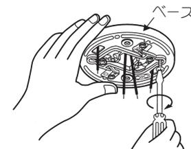
③電源用配線、外部出力用信号線を結線します。
