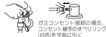
ガスコンセント 接続の場合、コンセント継手のすべりリング(白色)を手前に引く
