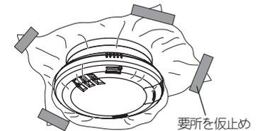
※ポリ袋と天井面の間に隙間ができないように、接着テープを貼ってください。特に、ポリ袋がしわになっている部分に注意してください。
