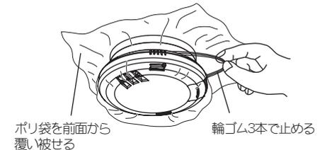
②ポリ袋と天井の隙間から噴射ガスが侵入するのを防ぐため、ポリ袋の端を接着テープで天井面に貼り付けてください。
