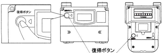
※『○B○C』の組み合わせは、しゃ断理由により異なります。また、復帰ボタンを押した時の『A○○』表示は、電池電圧低下とは異なります。
