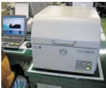
材料検査装置 (エネルギー分散型蛍光X線分析装置)
