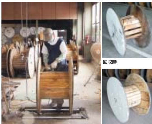
木製ドラムの補修作業
