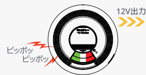
緑(電源)ランプ点滅 赤(ガス警報)ランプ点灯
